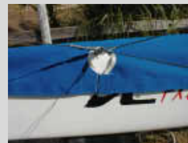
Cut out around the shrouds, mast, and bridle support and attached with velcro Découpe et attache par Velcro autour des haubans, du mât, des supports de brides.
